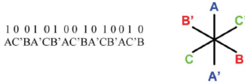
Fig. 9. Ordinea de succesiune a fazelor pentru înfășurarea trifazată concentrată.
