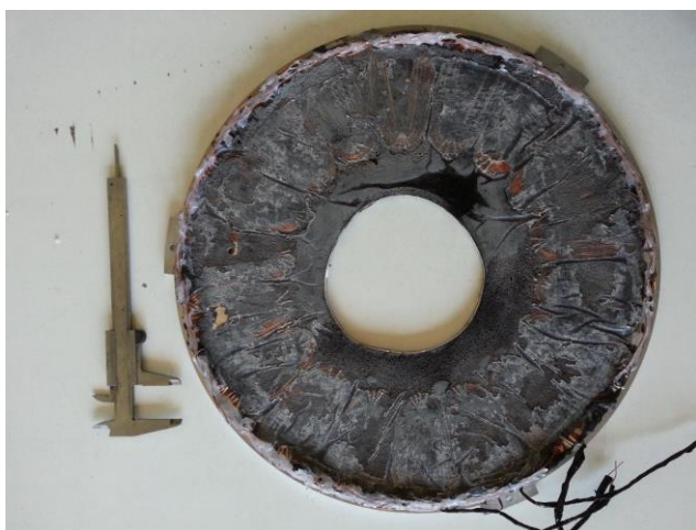
Fig. 7. Stator cu înfășurare trifazată al prototipului de microaerogenerator electric cu magneți de ferită și flux magnetic axial.
