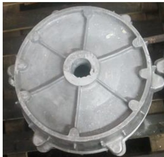
Fig. 6. Corp semicarcasă prototip de microaerogenerator.
