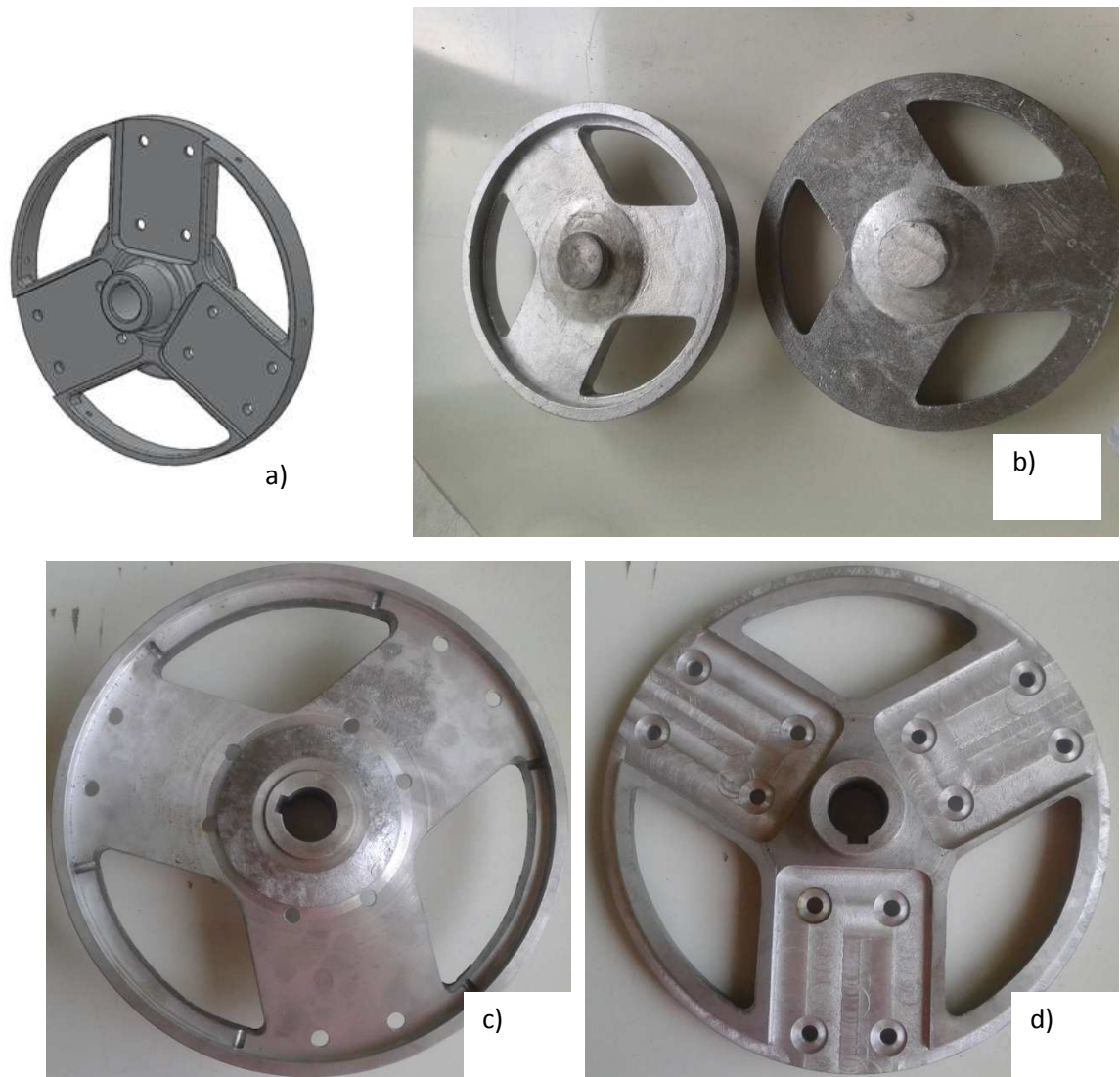
Fig.9 Suport pale (a) modelulgeometric al suportuluipalelor; b) suport in stare brut turnata; (c-d) suport pale dupa prelucraremechanica.
