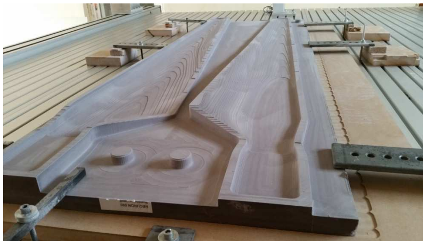
Fig. 12 Semimatrile din NECURON 690 aflate in faza de pre-finisare.
