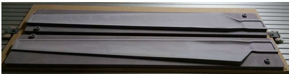
Fig.13 Semimatrile din NECURON 690 finisate.
