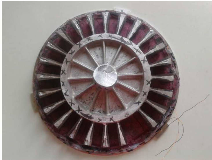
Fig.8 Ansamblul rotor-poli in stare brut turnata.
