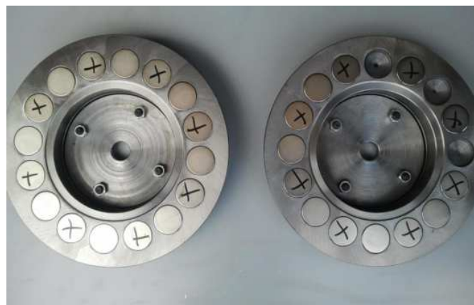
Fig. 2. Discurile rotorice: a) fără magnet permanent, b) cu magnet permanent.
