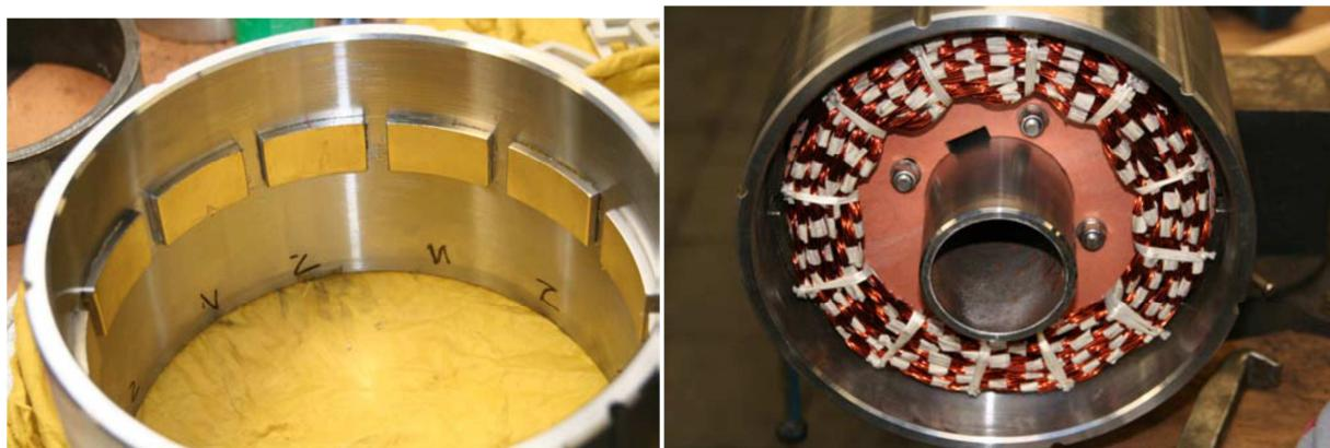
Fig.2 (a) Rotorul exterior cu unul din cele doua randuri de magneti lipiti pe jugul rotoric [1]
