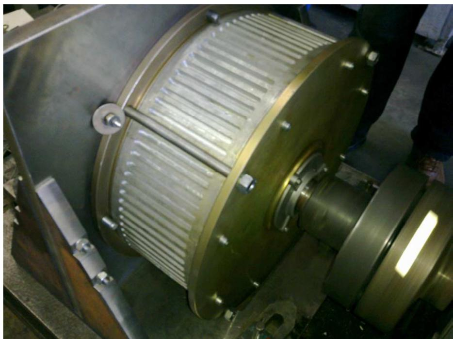
Fig. 5 Fotografie a generatorul de 5 kW [3]
