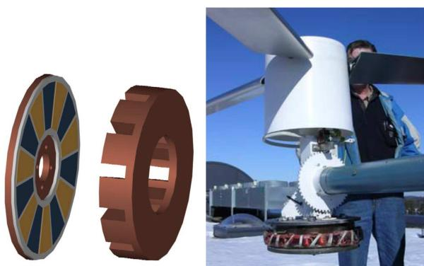
Fig. 7 (a) Structura generatorului, (b) Generatorul ca parte integranta a turbinei [5]
